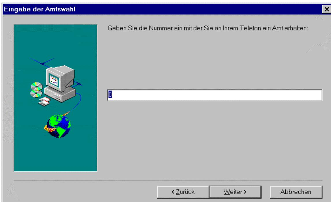
Falls das Modem an eine Telefonanlage angeschlossen ist, muss als nächstes die Amtsziffer (Ziffer um ein Amt zu erhalten) eingegeben werden. In der Regel ist dies die 0 oder die 9.
